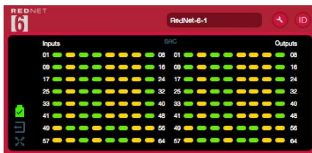
La ilustración anterior muestra un RedNet 6, con señal presente en todos los canales y una conexión de red bloqueada con los SRC apagados.
